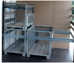
Quer zur Fahrtrichtung können wahlweise auch AJS-Zurratten eingehängt werden, mit deren Hilfe Teilladungen gesichert werden.
