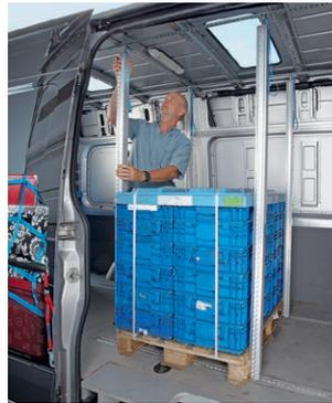
Zur Sicherung der Fahreigenschaften sowie Einhaltung der Achslasten ist die Ladung im Transporter auf der Hinterachse und mittig zwischen den Radkästen zu platzieren.
