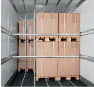
KIM 44 Profi kann als einzige Sperrstange im Transporter vertikal und horizontal eingesetzt werden.
