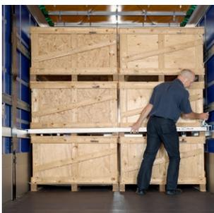
PAT kann auf Bordwände, Spriegelbretter und Zurratten eingehängt werden. Nach leichter Belastung verkanten die Verschlüsse und sitzen formschlüssig.
