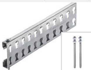
Um die Belastung der AJS-Zurrlatten in die Fahrzeugstruktur einzuleiten, ist die Ausstattung einer Reihe AJS-Zurrlatten mit Arretierbolzen erforderlich. Diese verbinden die AJS-Zurrlatten mit den Spriegeltaschen der Rungen von der Stirnwand bis zum Heckrahmen. Die Spriegeltaschen sind je nach Typ für die Aufnahme des Arretierbolzens nachzuarbeiten.
