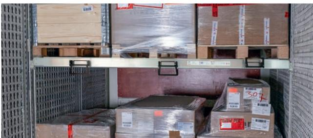
Zur rückwärtigen Ladungssicherung wird der letzte STD-Ladebalken mit Palettenstop verwendet.
