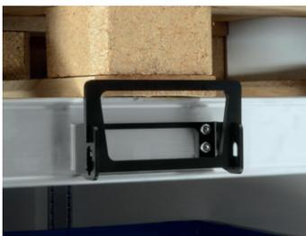
Drei Palettenstopper werden an dem letzten STD-Ladebalken befestigt. Nach dem Beladen der STD-Ladebalken werden die Palettenstopper einfach in die Sicherungsposition gebracht.
