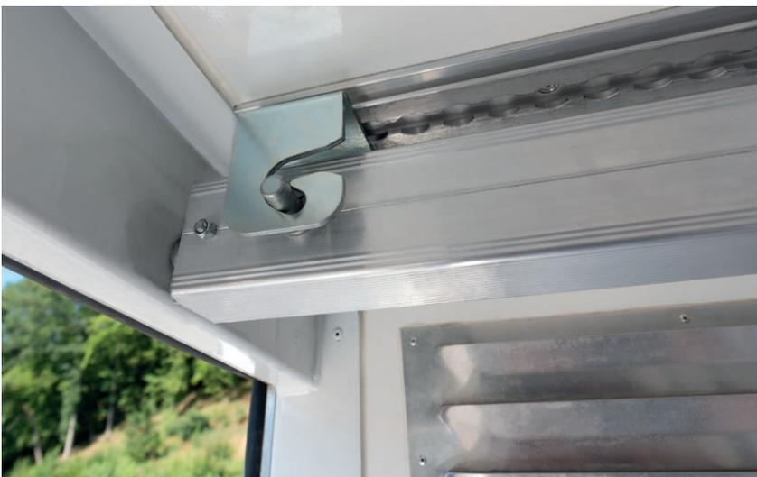
Zum Be- und Entladen werden die KIM-Sperrstangen sicher unter der Decke geparkt.
