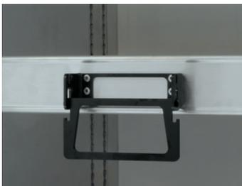
Vor dem Entladen werden die Palettenstopper in die Parkposition gebracht. In dieser Position können die STD-Ladebalken unter dem Dach geparkt werden.
