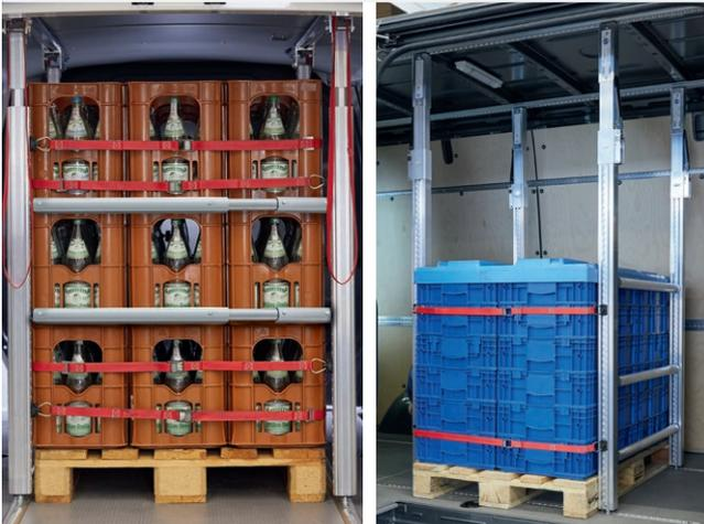
An den Querstreben der Dachkonstruktion wird die durchgängige Deckenschiene befestigt. Diese muss durch geeignete Befestigungselemente mit der Stirnwand und dem Heckportal verbunden werden. Die auftretende Belastung wird dadurch gleichmäßig in die feste Fahrzeugstruktur eingeleitet.
