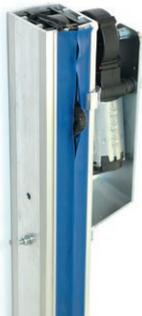
In den stabilen Holmen aus einer besonderen Aluminiumlegierung laufen speziell entwickelte Gleiter, an denen das Netz fixiert ist. Diese sorgen dafür, dass die Ladung jederzeit gut gesichert ist. In der Stadt und auch im Überlandverkehr.
